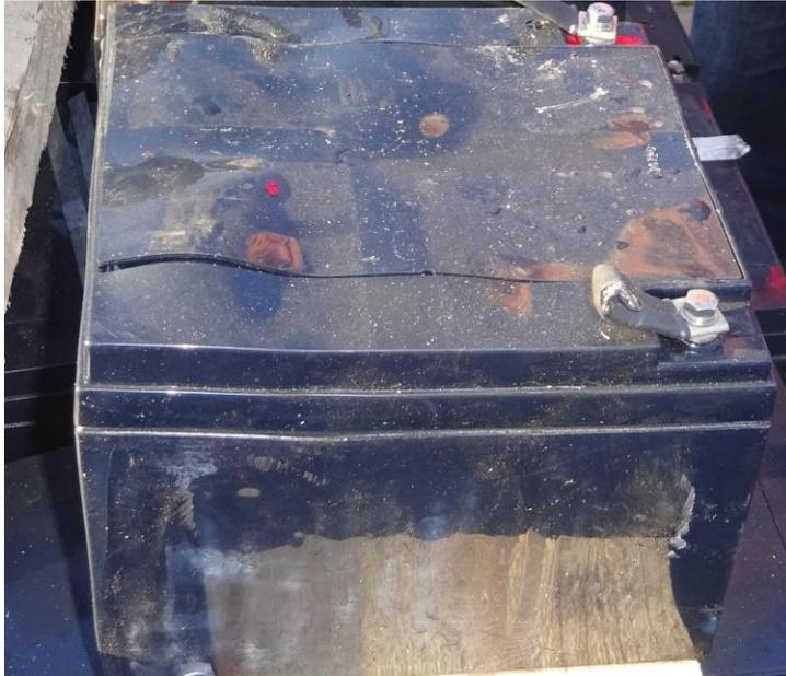
Durch weitere Veränderungen in den Akku-Zellen kann sich eine Zelle so weit erhitzen (insbesondere durch den Ladestrom verursacht), dass sie brennt. Damit brennt dann in der Regel der gesamte Akkupack.
